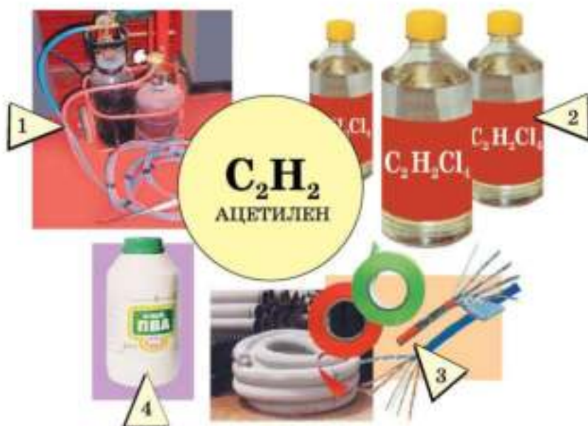
Рис. 24. Применение ацетилена: 1 — резка и сварка металлов; 2—4 — производство органических соединений (растворителей 2, поливинилхлорида 3, клея 4)
