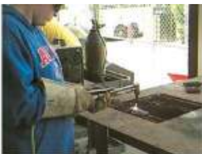
Рис. 22. Ацетиленокислородное пламя используют для резки и сварки металла
