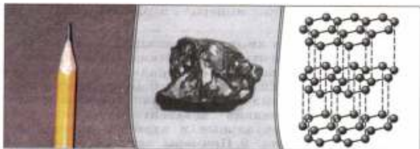
Рис. 13. Графит — вещество с атомной кристаллической решёткой
