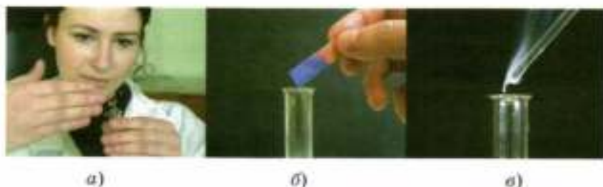
Рис. 65. Распознавание аммиака: а — по запаху; б — по изменению окраски индикаторной бумажки; в — по появлению дыма при поднесении стеклянной палочки, смоченной соляной кислотой
