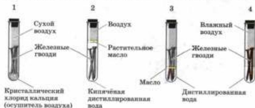
Рис. 121. Коррозия железа в различных условиях
