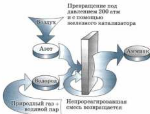
Рис. 107. Схема промышленного получения аммиака
