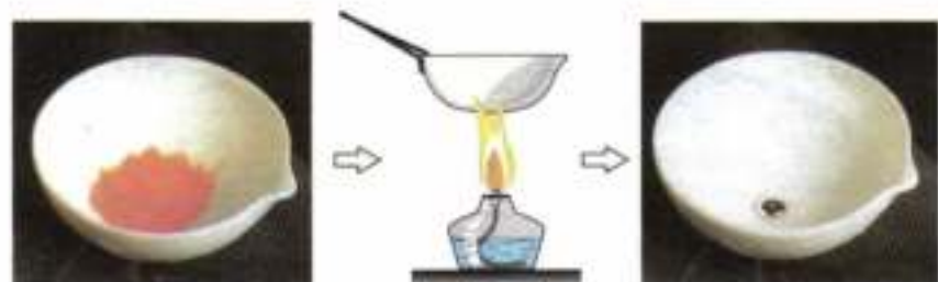
Рис. 94. Получение кислорода разложением оксида ртути
