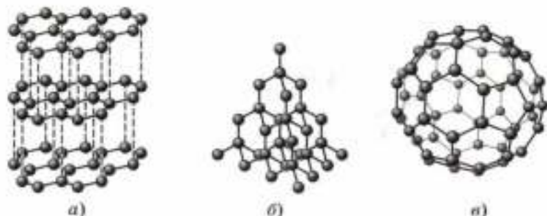
Рис. 45. Неорганические полимеры, имеющие атомную структуру: а — графит; б — алмаз; в — фуллерен
