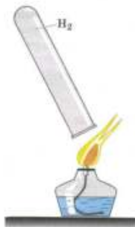
Рис. 54. Проверка водорода на чистоту
