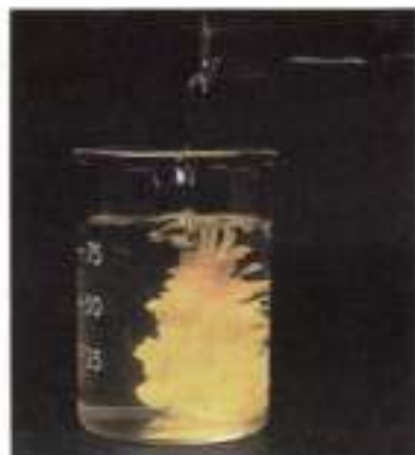
Рис. 100. Образование осадка иодида свинца (II) в результате реакции обмена
