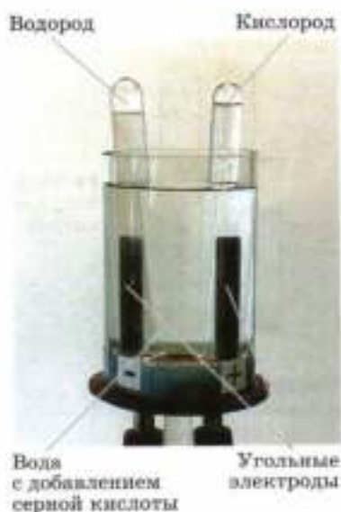
Рис. 114. Электролиз воды в лабораторных условиях
