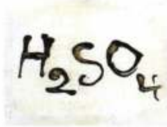
Рис. 129. Обугливание бумаги концентрированной серной кислотой
