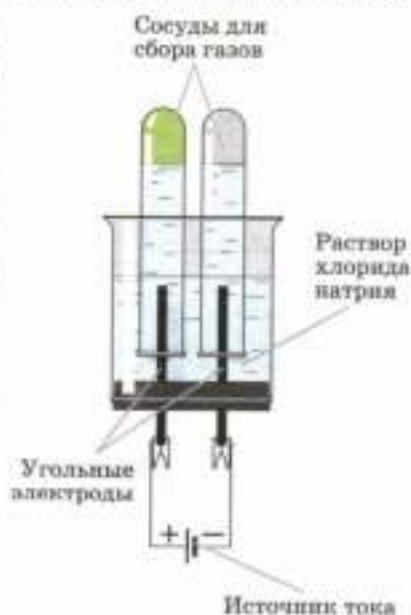
Рис. 113. Схема установки для электролиза раствора хлорида натрия в лаборатории
