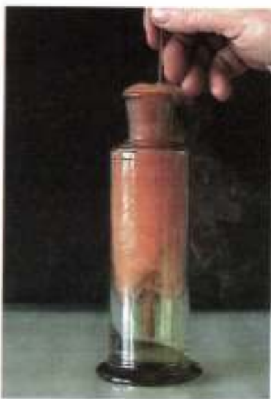
Рис. 116. Взаимодействие железа с хлором
