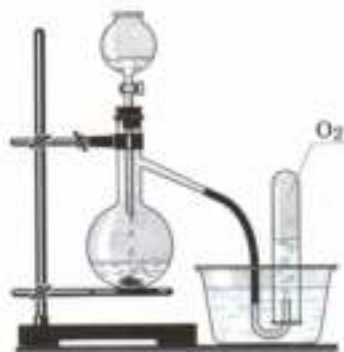
Рис. 60. Получение кислорода в лаборатории разложением пероксида водорода и со- бирание его методом вытеснения воды
