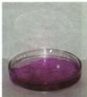
Рис. 96. Взаимодействие натрия с водой, в которую добавлен фенолфталеин
