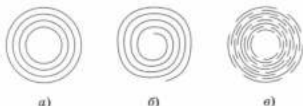
Рис. 149. Варианты поперечного разреза нанотрубок: а — «русская матрёшка»; б — «рулонный свёрток»; в — «папье-маше»
