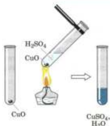
Рис. 130. Взаимодействие оксида меди (II) с серной кислотой
