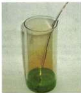
Рис. 128. Взаимодействие концентрированной азотной кислоты с медью сопровождается образованием бурого газа — оксида азота (IV)
