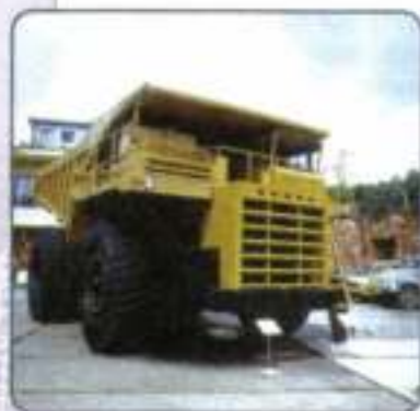
Большегрузный 180-тонный автомобиль БелАЗ
