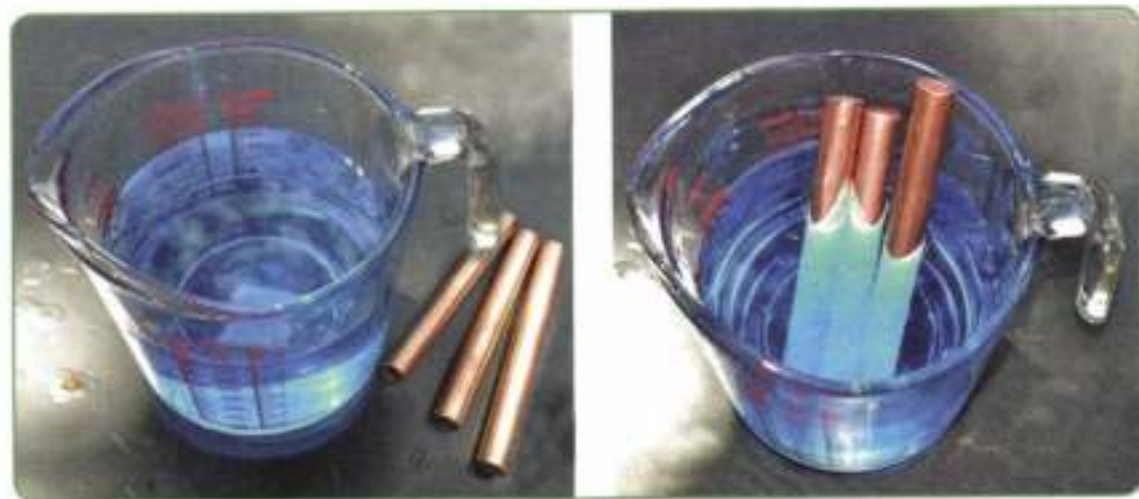
Рис. 61. Вытеснение серебра медью из раствора нитрата серебра
