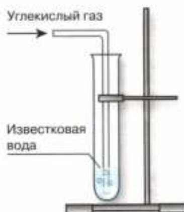
Рис. 51. Помутнение известковой воды — качественная реакция на углекислый газ
