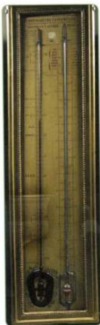
Рис. 6. Прибор на основе ртути — барометр
