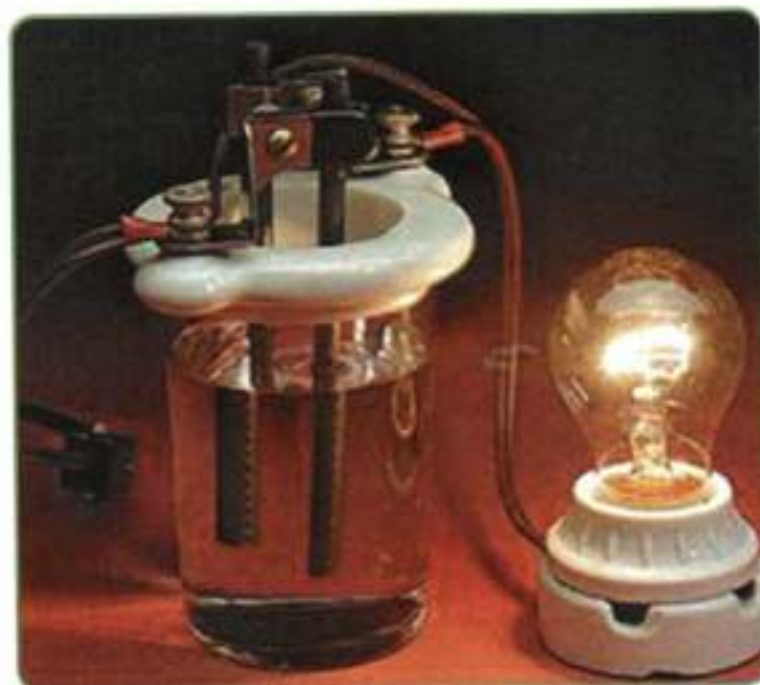
Рис. 58. Электролизёр — прибор для определения электропроводности растворов
