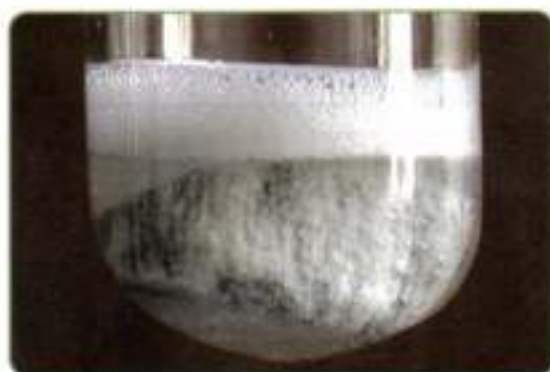
Рис. 32. Взаимодействие цинка с соляной кислотой
