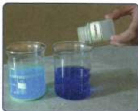
Рис. 110. Осадок гидроксида меди(II) (стакан слева) при добавлении глицерина растворяется, и образуется раствор ярко-синего цвета (стакан справа)
