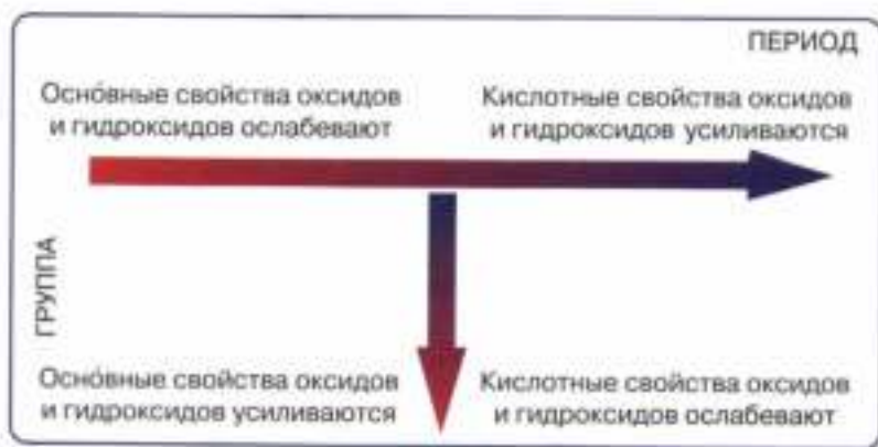
Рис. 3. Изменение кислотно-основных свойств высших оксидов и соответствующих им гидроксидов химических элементов в периодах и группах
