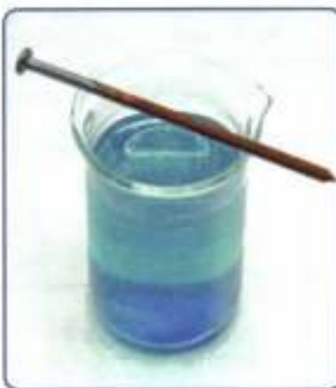
Рис. 7. В растворе сульфата меди(II) железный гвоздь покрывается медью
