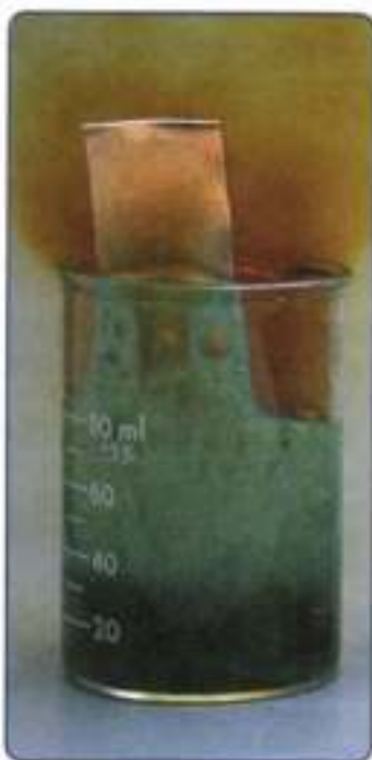
Рис. 91. При взаимодействии концентрированной азотной кислоты с медью один из продуктов реакции — оксид азота(IV)
