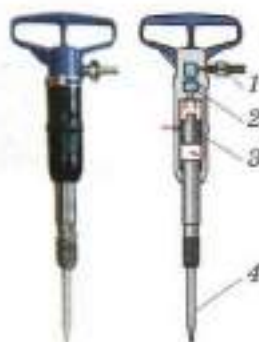
Рис. 104. Внешний вид и устройство пневматического молотка
