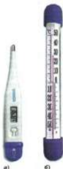
Рис. 11. Термометры: а — электронный; б — спиртовой
