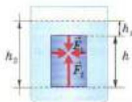
Рис. 148. Силы, действующие на погружённое в жидкость тело
