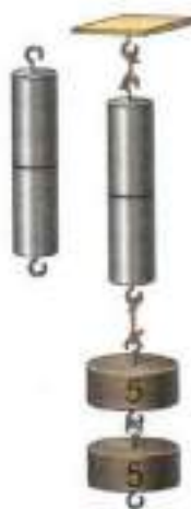
Рис. 26. Сцепление свинцовых цилиндров
