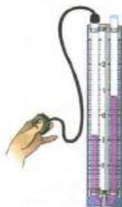
Рис. 138. Изменение уровня жидкости в коленях манометра
