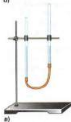
Рис. 116. Установление уровня жидкости в сообщающихся сосудах
