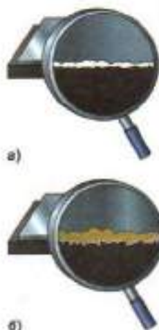
Рис. 82. Уменьшение силы трения с помощью смазки
