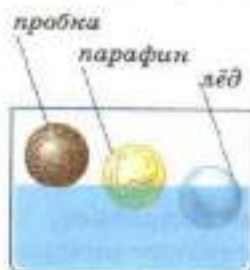
Рис. 155. Погружение в жидкость тел различной плотности
