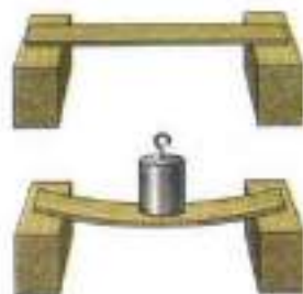
Рис. 64. Возникновение силы упругости
