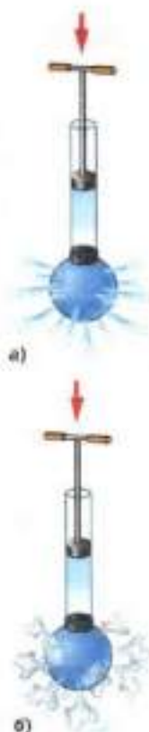
Рис. 100. Передача давления во все стороны без изменений: а — жидкостями; б — газами
