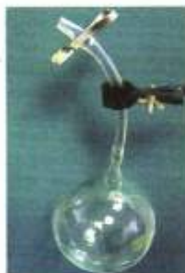
Рис. 124. Шар для взвешивания воздуха
