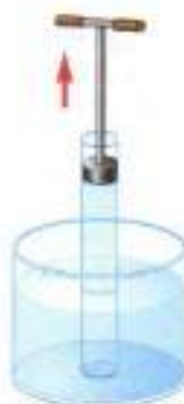
Рис. 125. Подъём воды вслед за поршнем
