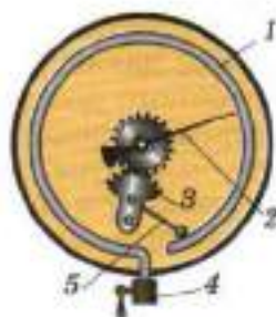
Рис. 141. Устройство металлического манометра
