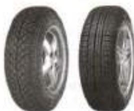
Рис. 86. Ребристые выступы на шинах позволяют увеличить трение
