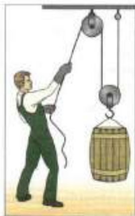
Рис. 181. Комбинация подвижных и неподвижных блоков — полиспаст
