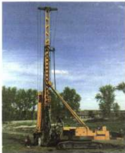
Рис. 194. Машина для забивания свай
