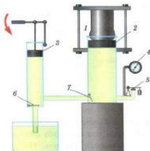
Рис. 145. Устройство гидравлического пресса
