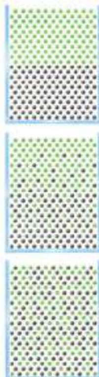
Рис. 24. Размывание границы раздела двух жидкостей при диффузии
