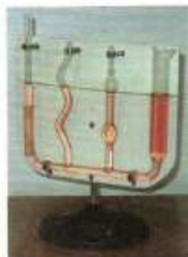
Рис. 118. Прибор, демонстрирующий установление уровня жидкости в сообщающихся сосудах
