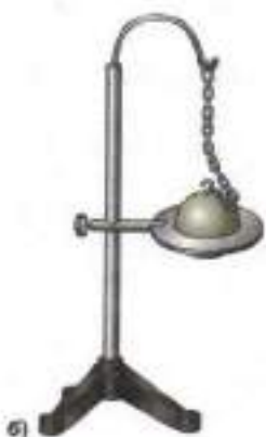
Рис. 18. Тепловое расширение металлического шара
