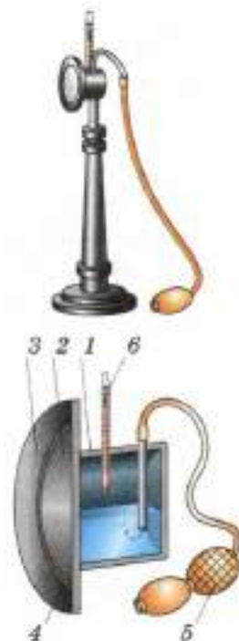
Рис. 23. Внешний вид и устройство конденсационного гигрометра
