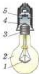
Рис. 87. Лампа накаливания: 1 — спираль; 2 — стеклянный баллон; 3 — цоколь; 4 — изолированное основание цоколя; 5 — пружинящий контакт патрона
