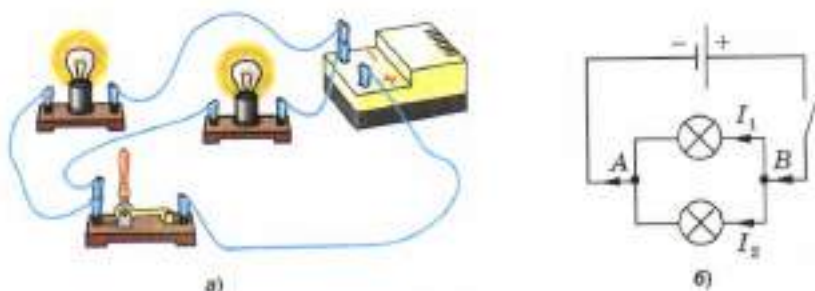
Рис. 79. Параллельное соединение лампочек
