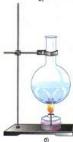
Рис. 9. Конвекция: а — в воздухе; б — в жидкости
