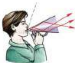
Рис. 82. Принцип действия рупора
