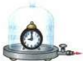
Рис. 80. Опыт, доказывающий, что в пространстве, где нет вещественной среды, звук не распространяется
