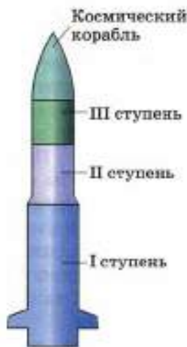
Рис. 49. Схема трёхступенчатой ракеты
