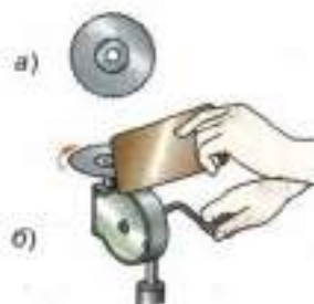
Рис. 79. Исследование зависимости высоты звука от частоты колебаний источника
