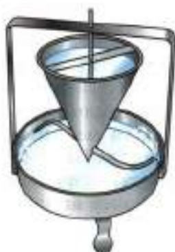
Рис. 46. Демонстрация реактивного движения с помощью сегнера колеса
