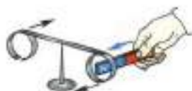
Рис. 123. При приближении к сплошному кольцу любого полюса магнита кольцо отталкивается от него
