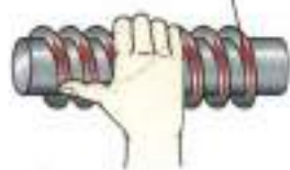
Рис. 97. Определение направления линий магнитного поля внутри соленоида
