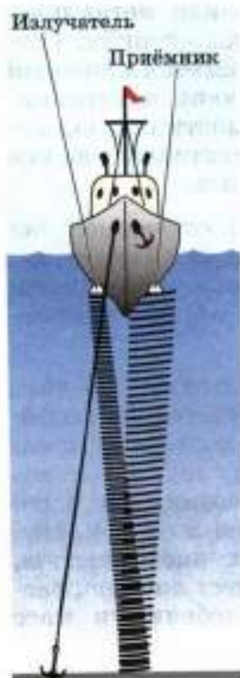
Рис. 78. Использование ультразвуковых колебаний для измерения глубины моря
