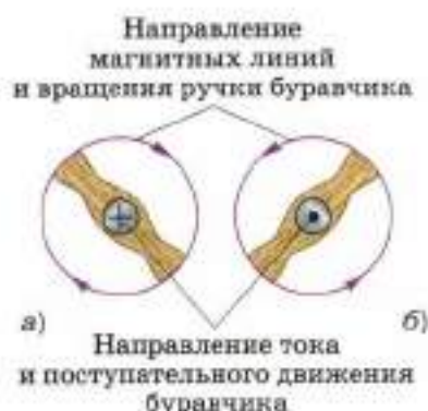
Рис. 95. Применение правила буравчика: проводник с током расположен перпендикулярно плоскости чертежа
