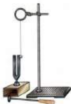
Рис. 76. Обнаружение колебаний ветвей звучащего камертона
