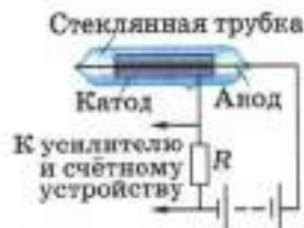
Рис. 159. Схема устройства счётчика Гейгера
