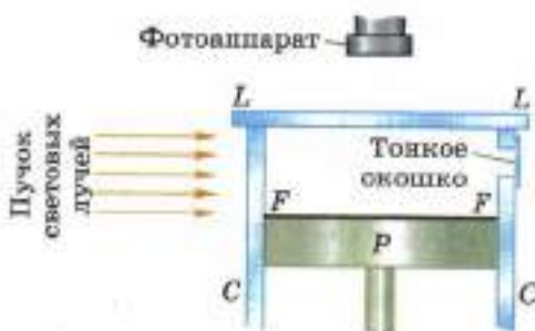
Рис. 160. Схема устройства камеры Вильсона
