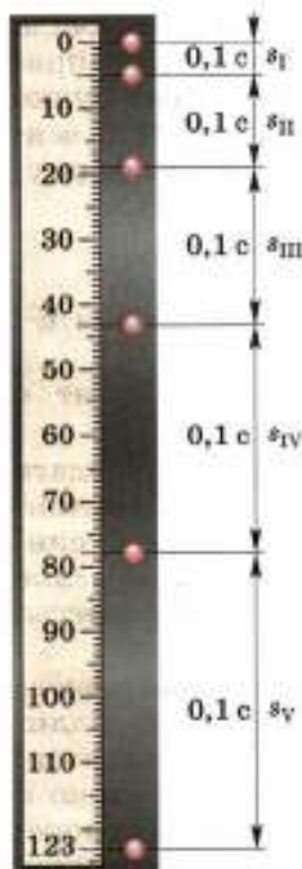
Рис. 28. Равноускоренное движение свободно падающего шарика
