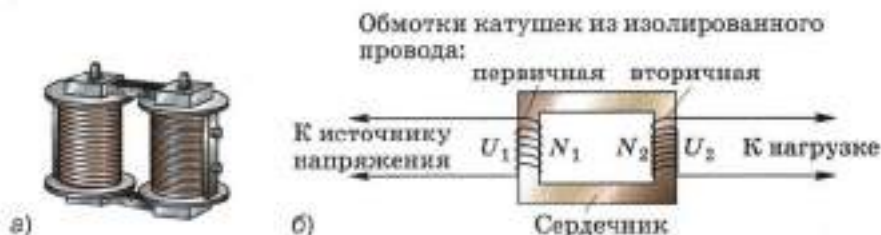
Рис. 134. Внешний вид и схема устройства повышающего трансформатора
