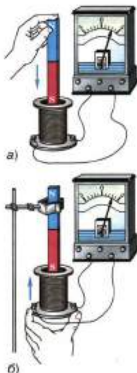
Рис. 119. Возникновение индукционного тока при движении магнита и катушки относительно друг друга
