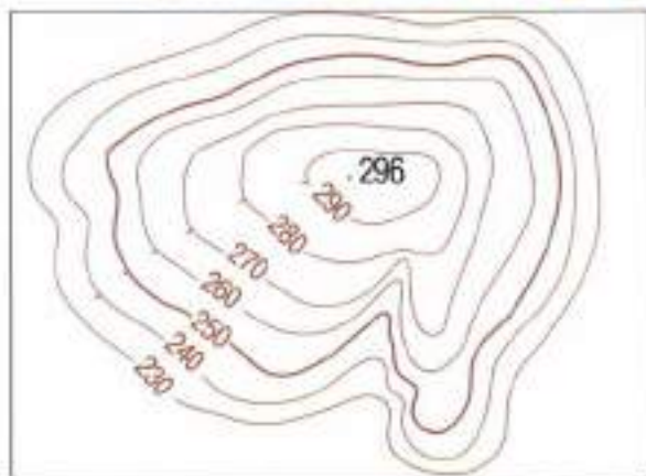
Рис. 59. Изображение холма с помощью горизонталей
