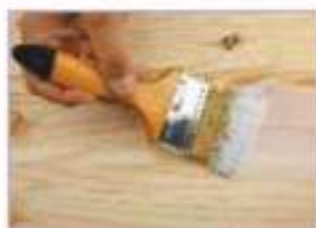
Рис. 6.7. Этапы склеивания деталей: а — смазывание клеем; б — сжатие струбцинами склеиваемых деталей
