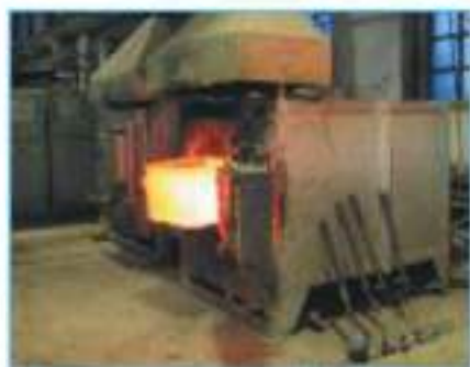
Рис. 5.2. Индукционная тигельная печь (а); муфельная печь (б)
