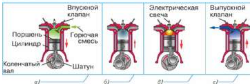
Рис. 4.11. Схема работы бензинового двигателя: а — всасывание воздуха; б — сжатие воздуха; в — впрыскивание топлива (рабочий ход); г — выпуск отработанных газов
