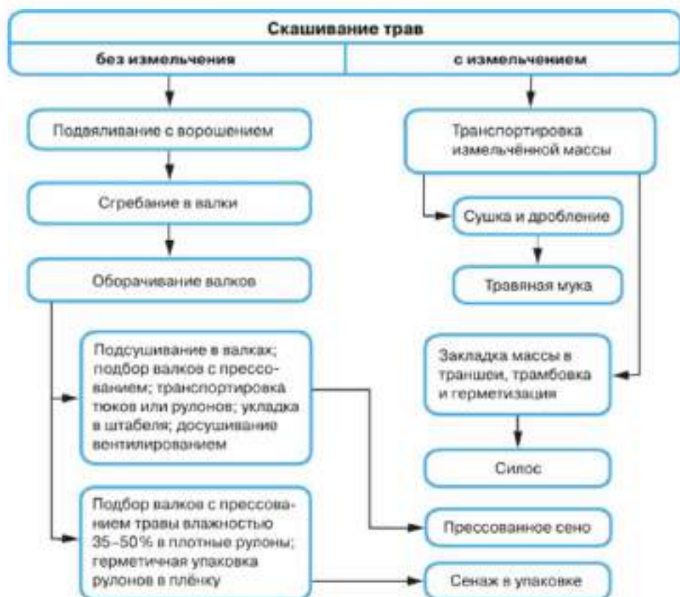
Рис. 11.3. Схема технологий заготовки травяных кормов
