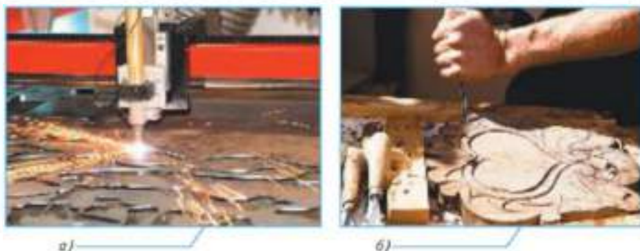
Рис. 3.2. Резание: а — лазером; б — механическими инструментами
