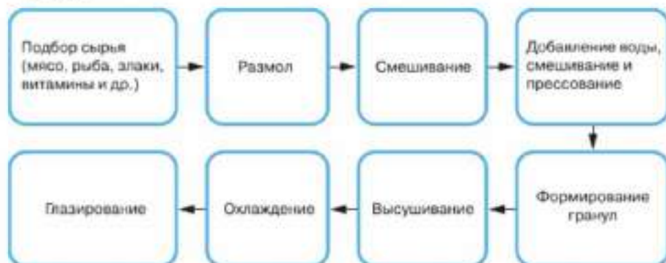
Рис. 11.11. Схема технологического процесса производства сухих кормов для кошек и собак
