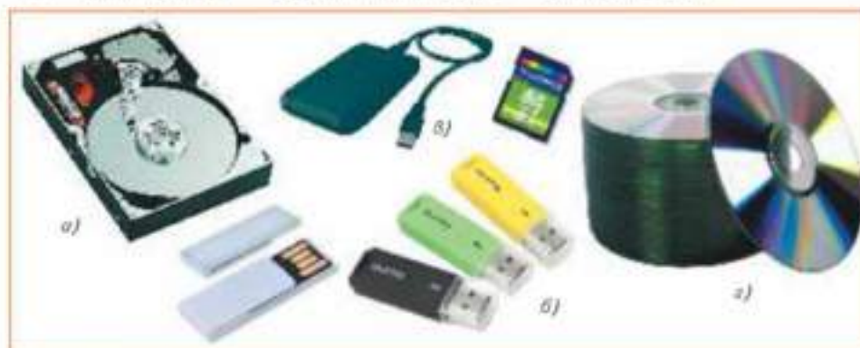
Рис. 8.1. Электронные носители информации: а — жёсткий магнитный диск; б — флеш-карты; в — USB-флеш-накопители; г — оптические диски
