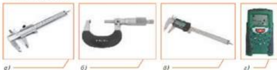
Рис. 2.4. Приборы для измерения линейных размеров: а — механический штангенциркуль; б — механический микрометр; в — электронный штангенциркуль; г — лазерный дальномер
