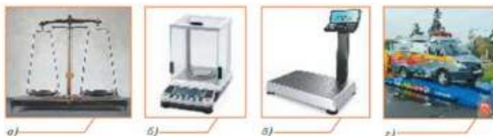
Рис. 2.5. Весы для взвешивания: а — лабораторные механические; б — лабораторные электронные; в — торговые электронные; г — автомобильные
