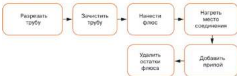
Рис. 5.5. Последовательность пайки
