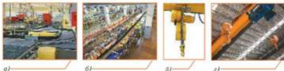
Рис. 13.7. Внутрипроизводственные фиксированные транспортные средства: а, б — конвейеры; в — электрическая таль (тельфер); г — мостовой кран
