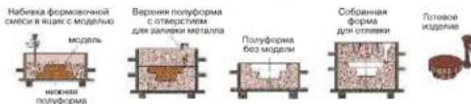
Рис. 5.3. Изготовление формы для отливки изделия
